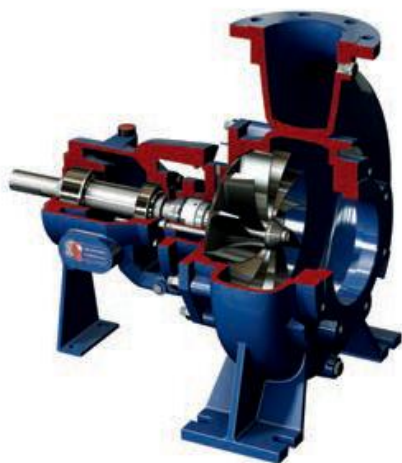
SPACCATO DI UNA POMPA CENTRIFUGA CON GIRANTE VORTEX
